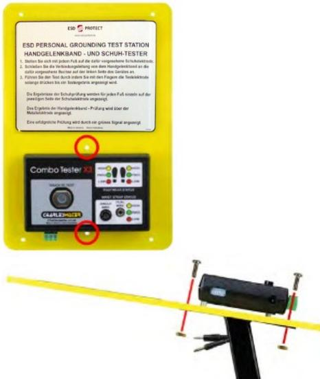
Abbildung 6: Versraubung der Montageplatte mit dem Standfuß
