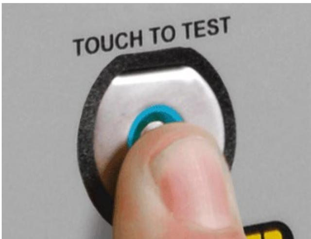
Abbildung 10: Start des Testprogrammes durch Überbrückung der beiden Sensoren.
